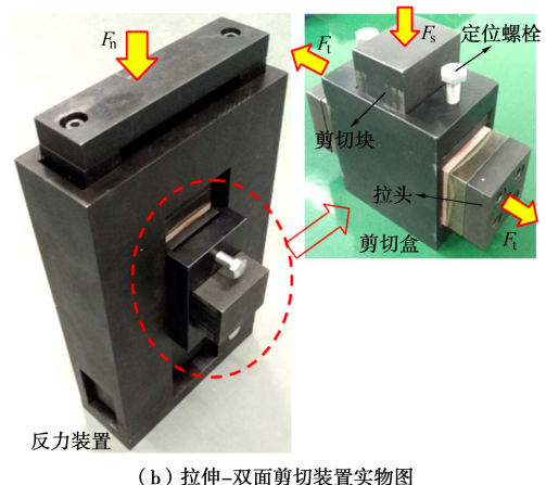
图 1 拉伸-双面剪切装置原理和实物图
