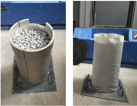
图 5 土工织物散体桩试样的制备
