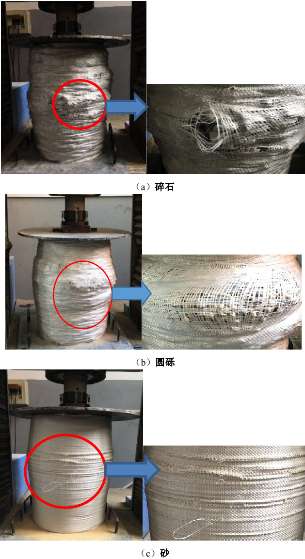
图 6 土工织物散体桩桩体破坏情况
