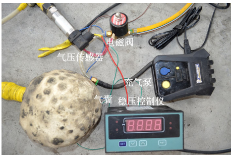
图3 溶洞内压控制装置
