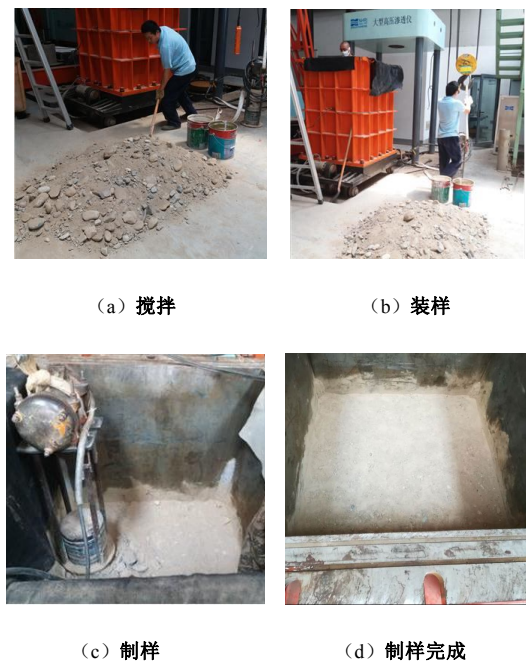
图 2 超大型渗透试样的制样
