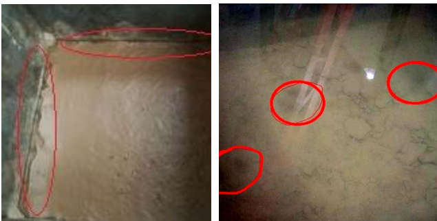
(a) 流土（上包线试样） (b) 管涌（平均线试样）
