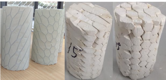
(a) 未脱模柱体 (b) 黏结好的试件
