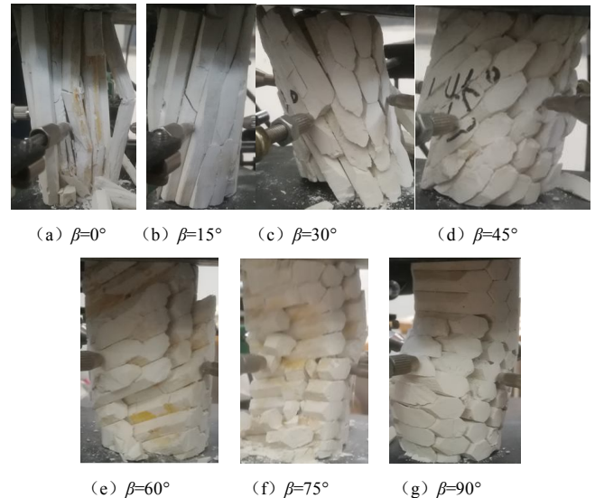
图 8 模拟柱状节理岩体试件典型破坏特征
