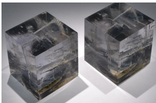
图1 裂隙煤岩 3D 打印模型 [19]
