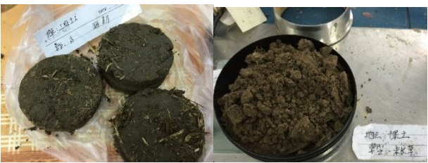
(a) 试验后三维土工网表层土样 (b) 试验后当地裸土土样
