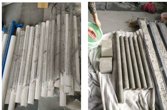
(a) PVC 管及铁丝笼 (b) 养护模型桩
