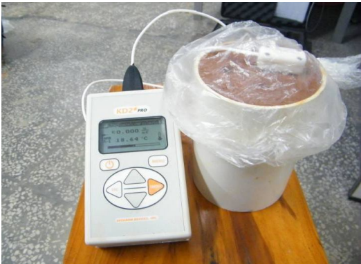
图 2 土样热物理特性参数测试过程 Fig. 2 Testing process of thermal properties of soil 试验过程如下:
