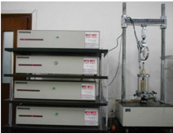
图 3 应力应变控制式三轴剪切渗透试验仪
