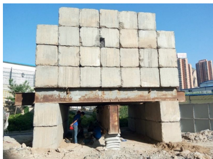
图3 试验现场单桩静载试验
