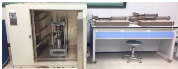
图 1 高温高压土工三轴仪
