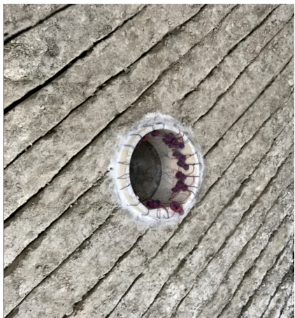
(b) 试验模型 图 3 层状围岩模型
