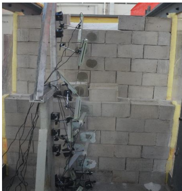
图 7 双级加筋土挡墙震害情况
