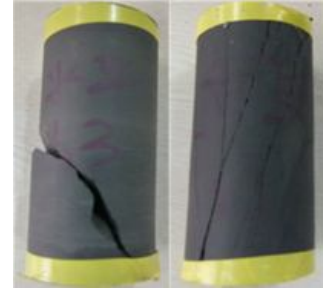
图 5 常规三轴压缩试验破坏后试样
