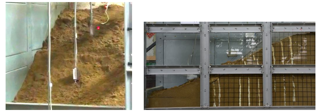
(g) 正弦波峰值 0.6g, 边坡最终状态, 顶部崩塌后堆积于坡脚
