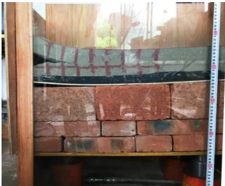
图11 侧限加筋土挡墙的实际变形形态
