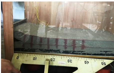
图12 无侧限加筋土挡墙的实际变形形态
