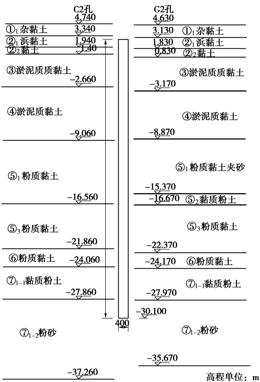
图 2 桩基剖面图(标高为绝对标高)
