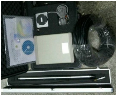
图 1 孔压静力触探探头
