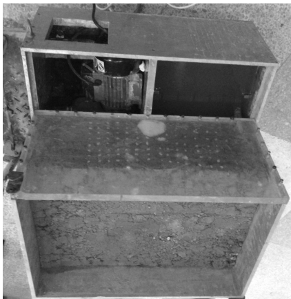
图 2 完整的离心机试验模型
