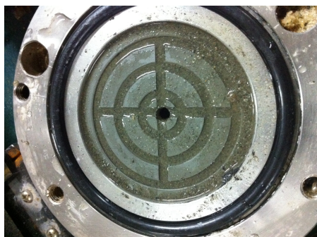
图5 土工织物覆粉砂渗透试验后渗透仪下筒顶部的照片
