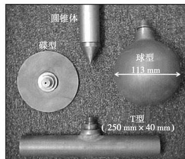
图 1 T 型、球型与碟型全流触探仪 [1]
