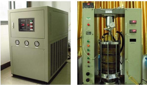
图 1 应力式三轴仪的温控系统
