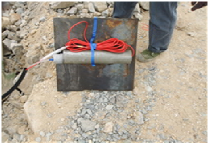
图 5 路基传感器与沉降板的固定
