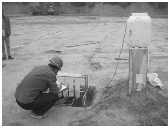
图 2 新型双环注水试验装置实物照片
