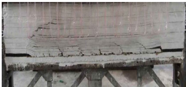
图 6 最终模型破坏情况
