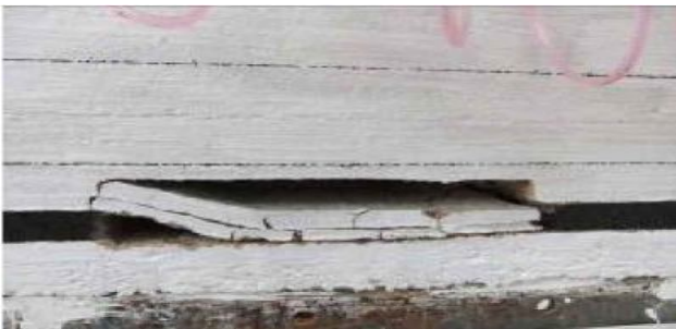
图 4 模型初次塌落
