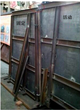
图 1 倾斜正断层倾向错动试验箱
