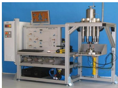
图2 TOP INDUSTRIE 自适应全自动岩石三轴试验机
