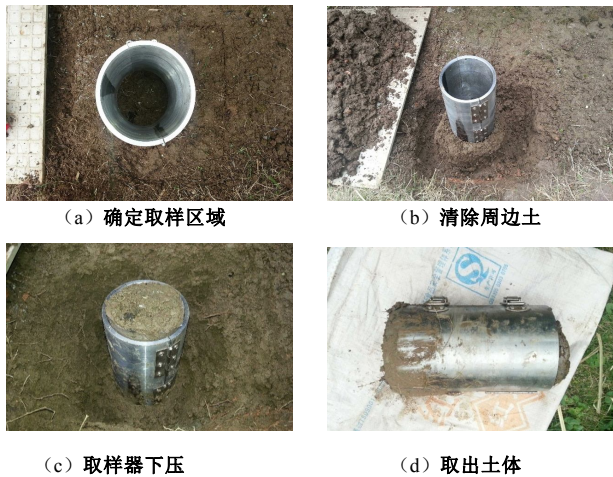
图 6 现场土样的获取过程
