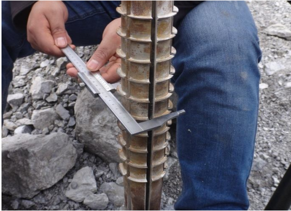
图 6 钻孔剪切仪剪切探头
