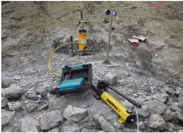
图 8 液压千斤顶及其附属测量装置
