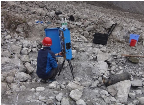
图 7 法向应力液压控制装置
