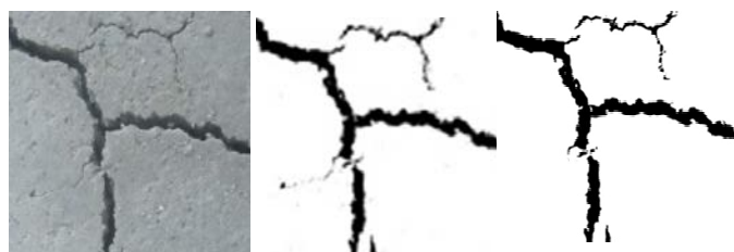
(a) 原图 (b) 二值化图 (c) 矢量化图
