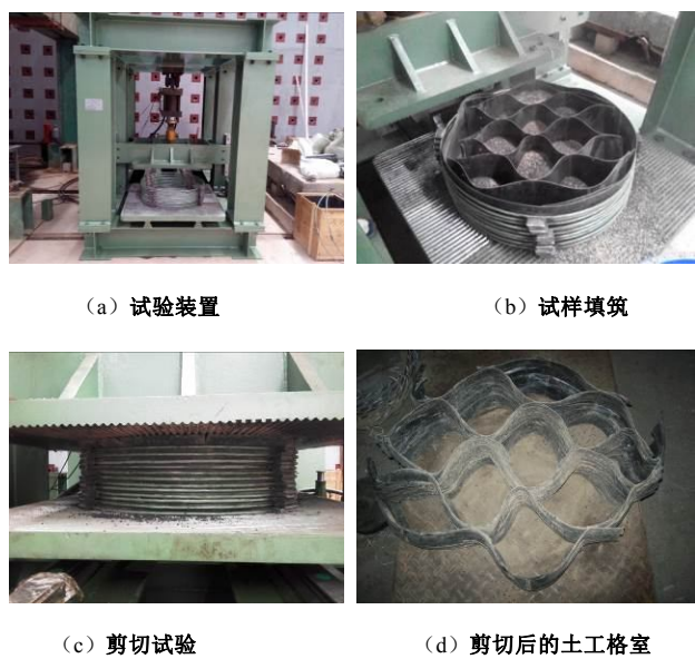
图3 本文大型循环剪切试验装置与试样
