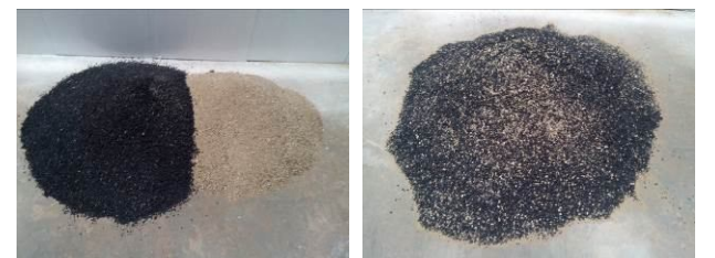
图 1 试验用橡胶颗粒、砂颗粒和混合后的橡胶砂 Fig. 1 Photos of rubber particles, sand particles and rubber sand mixtures
