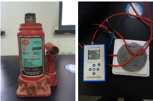
(a) 千斤顶 (b) 振弦式土压力计
