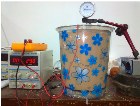
图 4 一维电渗固结试验装置
