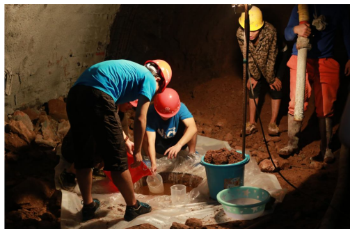
图2 现场灌水法测试样天然密度
