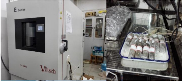
图 2 控温箱及冻结温度测量
