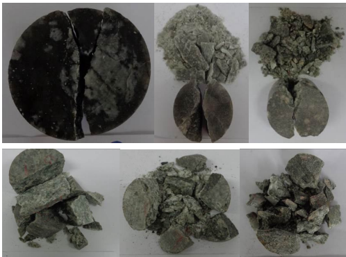
图 6 完整岩石破坏模式
