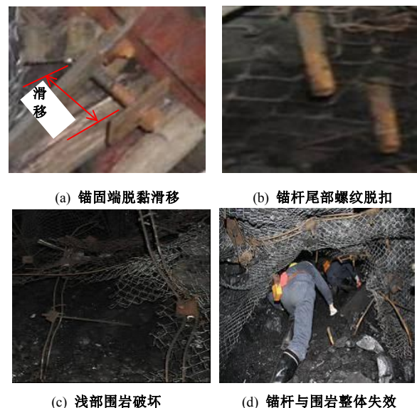
图 1 冲击载荷作用下锚杆典型失效形式
