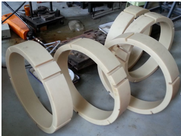
图 4 模型隧道管片环 Fig. 4 Segment rings for shield tunnel model
