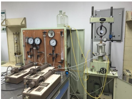
图 2 改进的应变控制式非饱和土三轴试验设备
