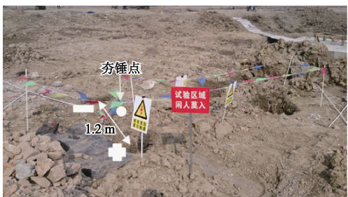
图 3 现场试验的电极布置
