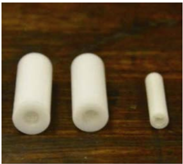
(c) 模拟试验锚杆自由段塑料套管
