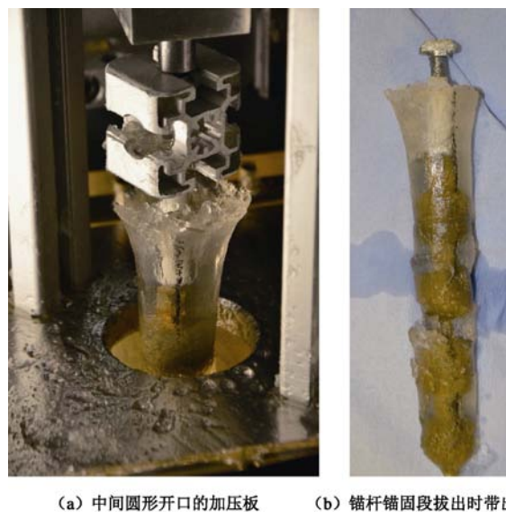
图7 加压板与B型连续球体锚杆拔出试验图
