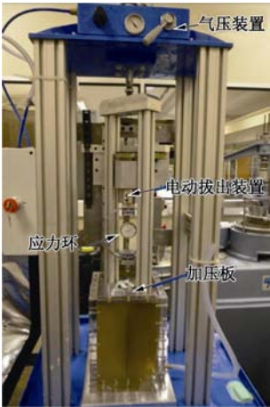
图 3 透明土试验控制与测试
