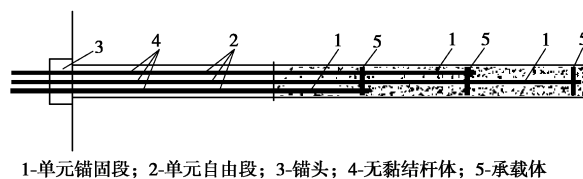
图5 国内规范中的压力分散型锚杆结构简图
