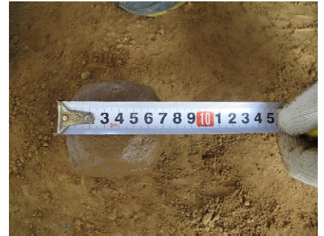
图 15 模型中用以模拟低阻的相似材料
