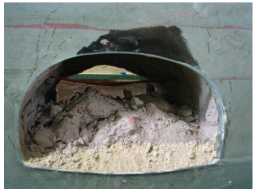
(d) 拱顶塌落成拱, \Delta P = 17.63 kPa
