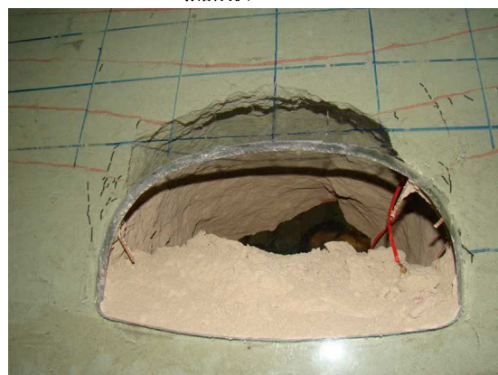
图 6 有锚杆支护时隧道围岩渐进性破坏过程照片
