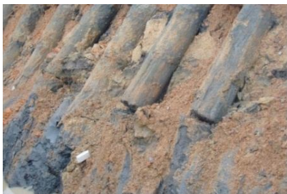
图 1 素混凝土桩复合地基失稳时桩体弯曲破坏
