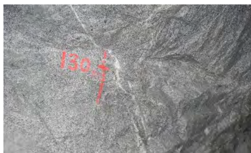
图9 PD19 洞深 0+130 m 下游壁 N50°E 裂缝附着石英脉
