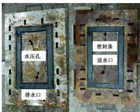
图4 耐水压力试验装置(组装前)
