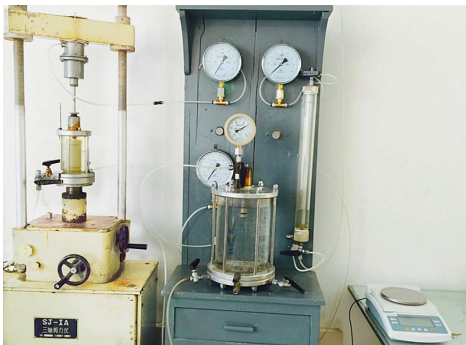
(b) 试验装置 图 1 三轴渗气仪
