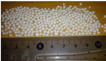
图 1 试样中添加的 EPS 颗粒
