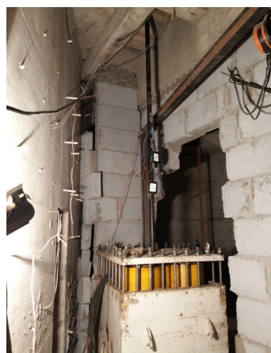
图 2 室内动力触探试验模型箱
